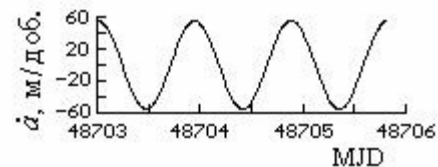
Рис.7. Швидкість зміни великої піввісі a орбіти супутника 65025A під дією сонячного випромінювання на інтервалі 3 доби.
