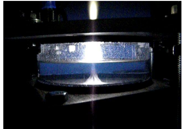
Рис. 2. Плазмово-рідинна система через 1 секунду після того, як запалили розряд: режим роботи – РА; струм – 280 мА; потік повітря – 5 л/хв.
